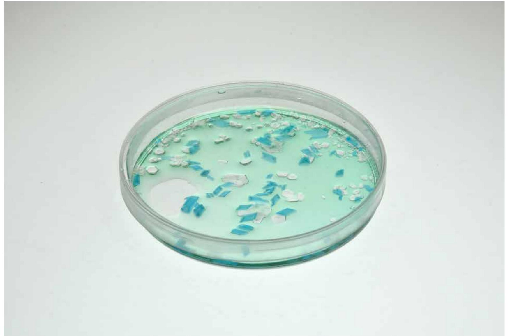
Les liquides saturés en sel, acide citrique, sulfate de fer et sulfate de cuivre peuvent se combiner et former un seul liquide homogène. Lors de l'évaporation ils laissent place à des cristaux qui n'ont pas la même forme, naissent à différents moments, certains se formant avant les autres tandis que d'autres fusionnent pour créer de nouvelles formes.
